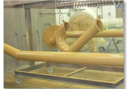
Applizierte Beschichtung **Proguard CN 200-LV2** im Innenbereich der Gülle-Transportbehälter sowie an entsprechenden Rohrleitungssystemen
