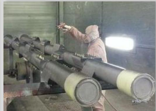
Unser chemiefestes Premium-Produkt **Proguard CN 200** wurde einschichtig auf die Wellengestänge und die Ständerwerke im Airless-Spritzverfahren aufgetragen.
