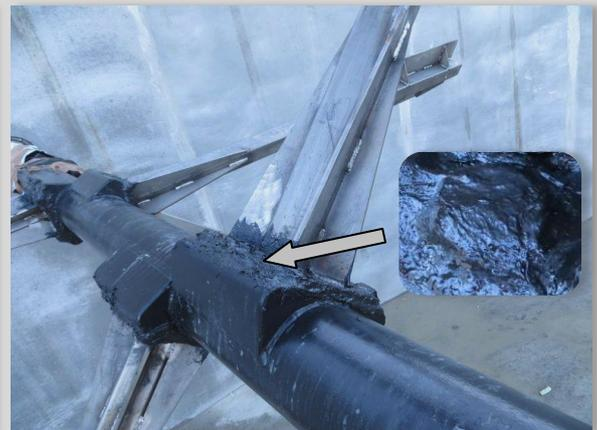
Das Wellengestänge und die Paddel befinden sich in der Wechselzone des Biogases und der Biomasse. Die Stahlkomponenten sind stetigen Schwankungen mit **Ein- und Austritten in den Gasbereich** ausgesetzt, dadurch wird eine **hochkorrosive Wirkung** hervorgerufen. Für diesen Anwendungsbereich ist ein Beschichtungssystem mit hohen Resistenzeigenschaften unerlässlich.
