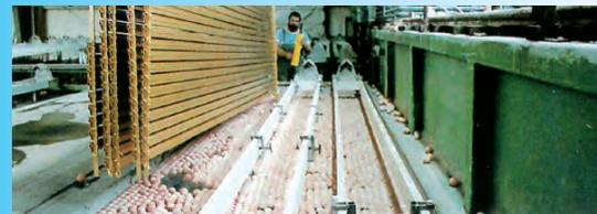
Beim Galvanisieren vermindern sie die Verdunstung weiterhin, da freiwerdende Luftblasen unterhalb der Kugeln festgehalten werden und dann langsam entlang der Kugeloberfläche entweichen, anstatt an der Oberfläche aufzuplatzen.
